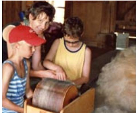
Aus dem dicken Wollbausch werden vorsichtig Wollfasern herausgenommen und auf die Walzenkämme der Kardiermaschine gelegt. Beim Drehen der Walzen werden die Fasern alle in eine Richtung gekämmt.
